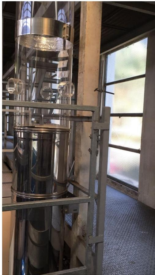
*Figura 2 condotto per la determinazione della portata*
