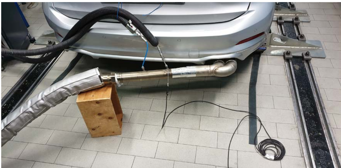
Captazione dei gas di scarico durante le prove in laboratorio.
