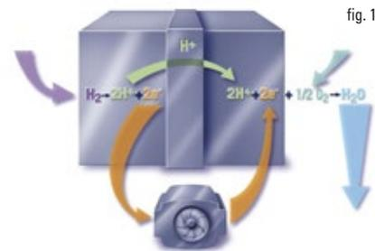
La *fuel-cell* è un dispositivo che converte l'energia chimica di un combustibile in energia elettrica, calore e vapore acqueo senza utilizzare cicli termici e parti in movimento.
